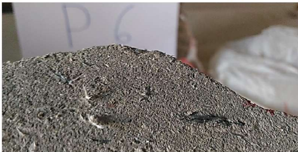
Figura 4 – ingrandimento delle fibre di crocidolite a vista nel precedente frammento in P6
