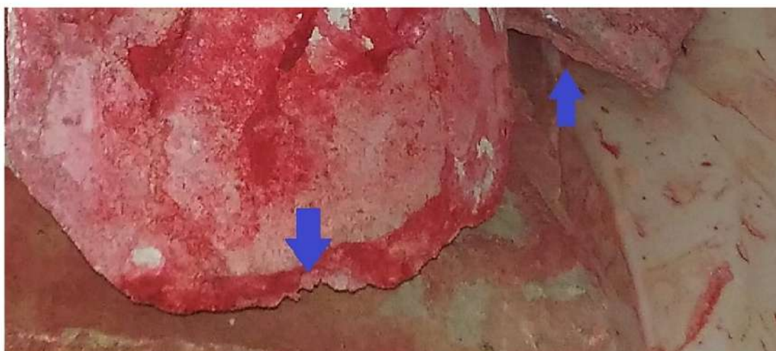
Figura 2 – evidenza dei bordi netti del punto di rottura di un frammento in P19
