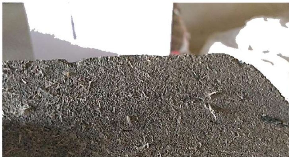
Figura 3 – frammento P6 in cui sono ancora presenti a vista ciuffi di fibre di crisotilo (in bianco) e sulla dx di crocidolite (cfr. figura 4)
